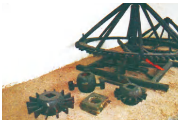
牛戽水车车座,架于河边的水车墩上,以牛拉动而戽水灌溉。淘汰于20世纪五十年代。
