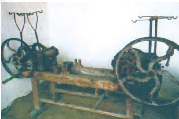
手摇面机:铁木制成,供摇面用。现改用电动机作动力,不再手摇。
