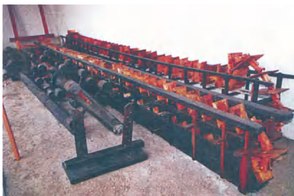
图中有长车两部,六人轴一根,水架一个,扶桁一根,塔枕一付。是所谓农家全套车水工具。20世纪五十年代后逐渐被戽水机,电灌站所替代。
