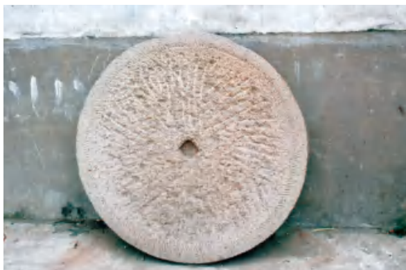
大石磨:金山石凿成,有上下两并用牛拉动磨粉用,有了电动轧粉机后被淘汰。
