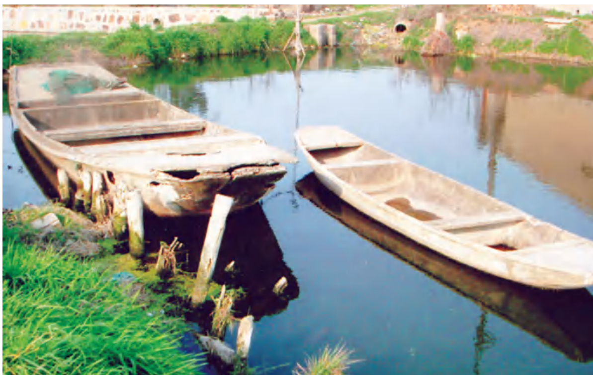
水泥船：用水泥、钢筋网制成，用于运输、畚河泥，现已淘汰。
